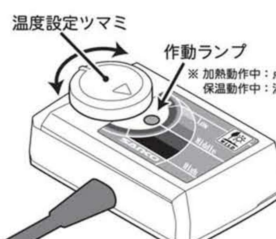
設定温度は、発熱体表面の温度です。保温目的の位置の温度確認は必ず温度計を設置してご確認下さい。
