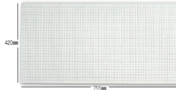
C34WS (イージーホームエポ80 WS用) ワイヤーメッシュ・スノコ サイズ: 755×420mm メッシュピッチ: 約12×12mm 入数 10入
