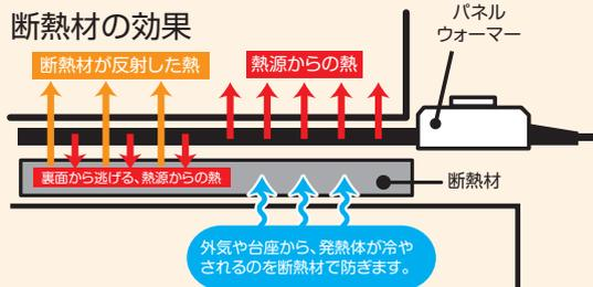
一般的な使用方法を見ると非常に熱効率が悪い使い方をされています。断熱材を使用すると熱源が発生させた熱が有効に利用され、表面温度が安定し消費電力も少なくなります。
