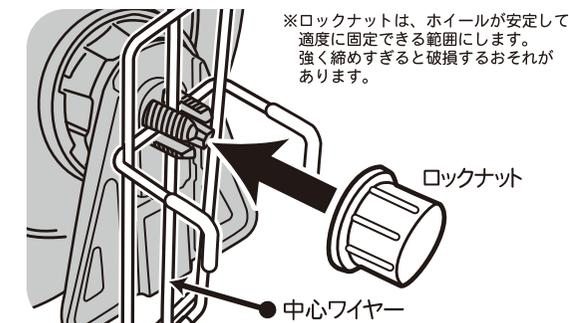
※ロックナットは、ホイールが安定して適度に固定できる範囲にします。強く締めすぎると破損するおそれがあります。
