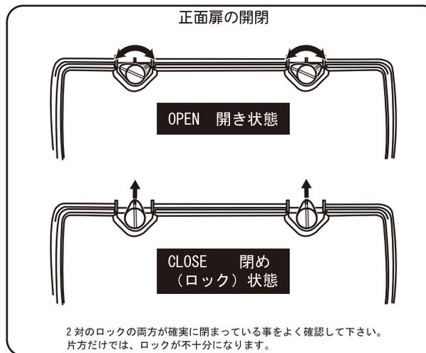
2対のロックの両方が確実に閉まっている事をよく確認して下さい。片方だけでは、ロックが不十分になります。
