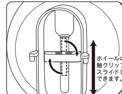
ホイールの高さは軸クリップ位置をスライドして調整できます！
