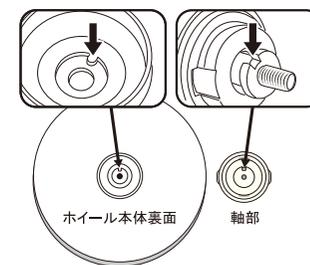
※凹凸が合っていないと、正確に取り付けが出来ず、ホイールが回転した時に大きなブレや異音が発生します。
