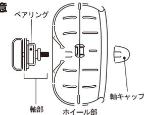
軸部を取り付ける際は、ホイール本体の裏面にある突起(凸)と軸部のくぼみ(凹)をピッタリと合わせて差し込んでから、軸キャップを取り付けて下さい。
